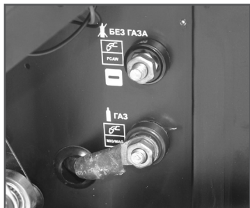
Рис. 10 Клеммы подключения кабеля механизма подачи проволоки
