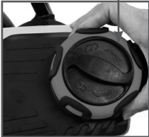
Рис.7 Регулировка натяжения цепи
