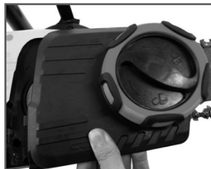
Рис.6 Установка крышки шины
