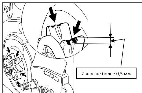
Рис.10 Проверка износа звездочки
