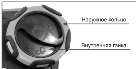
Рис.2 Регулятор натяжения цепи
