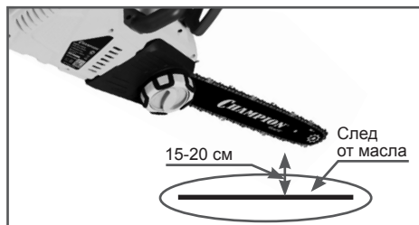
Рис.9 Проверка подачи масла
